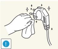
С помощью сухой ткани удалите пыль вокруг контактов вилки питания или розетки электросети.
