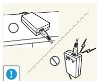
При установке блока питания переменного тока/постоянного тока с подвешенным кабелем, направленным вверх, вода либо другие посторонние вещества могут проникнуть в адаптер и послужить поводом к его отказу.
