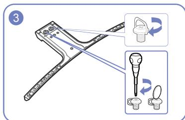
Полностью закрутите соединительный винт в нижней части подставки, чтобы как следует зафиксировать соединительный элемент.
