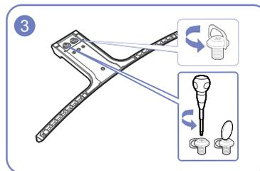
Открутите соединительный винт в нижней части подставки.
