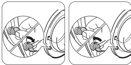
**Для включения** этого устройства поверните по часовой стрелке кнопку с внутренней стороны дверцы (не нажимая ее) так, чтобы паз пришел в горизонтальное положение. При необходимости используйте для этого монету.
