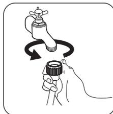
Присоедините другой конец наливного шланга к водопроводному крану с резьбой 3/4. Всегда используйте шланг, поставляемый вместе с прибором.
