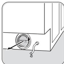
Когда вода перестанет течь, отвинтите крышку насоса, повернув ее против часовой стрелки, и извлеките фильтр. При необходимости используйте плоскогубцы. Всегда держите под рукой тряпку, чтобы вытереть воду, которая может пролиться при снятии фильтра. Очистите фильтр под крышкой от следов ворса.
