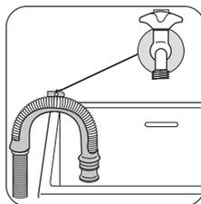
Подвесить над краем раковины, используя пластмассовую направляющую сливного шланга.
